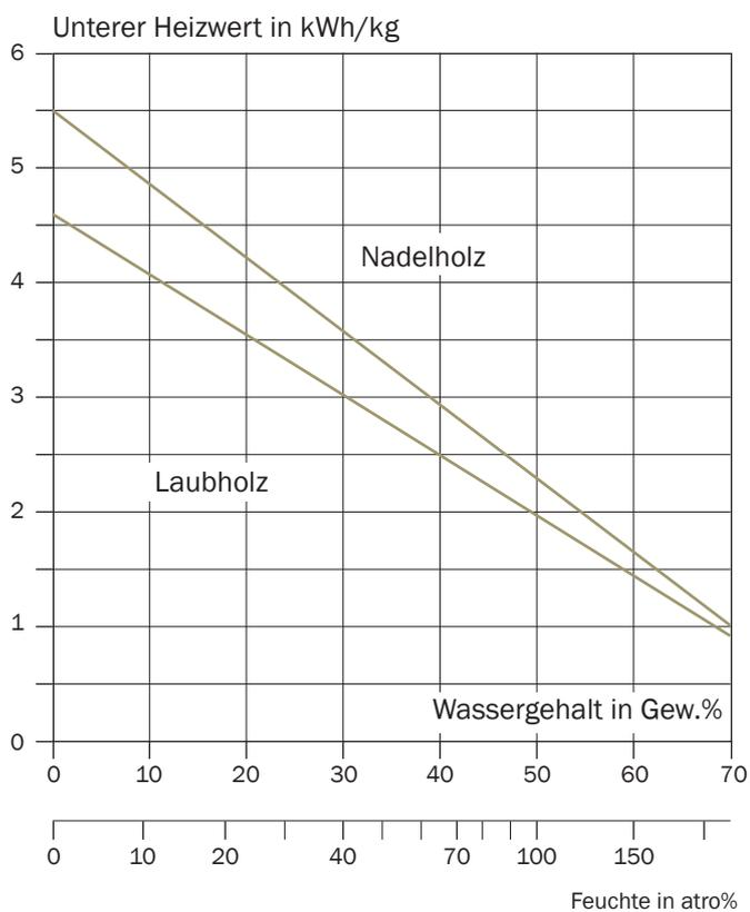
◀ Heizwert von lufttrockenem Derbholz in kWh pro rm (gerundet auf 100 kWh/rm) bzw. in kWh/kg für verschiedene Holzarten (Feuchte: 15 bis 18% v. Darrgewicht)
